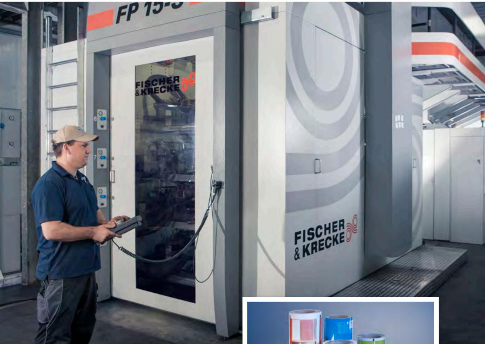
Unsere 8-Farben-Flexodruckmaschine ist für die Bedruckung aller üblichen Materialien zur Produktion flexibler Verpackungen ausgelegt
